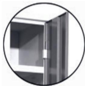
**KORPUS:** Die Konstruktion besteht aus elektrolytisch verzinktem Stahlblech und ist 0,75 mm stark. Durch spezielle Umbüge der Holme, Seitenwände und der Rückwand sowie punktgeschweißte Verbindungen wird eine hohe Stabilität erreicht. Die 20 mm negativ eingebaute Rückwand gewährt eine zusätzliche Steifigkeit.
